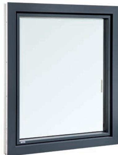
Das Fenster der Zukunft, das die besten Energiespar-Technologien in sich vereint: Extrastarkes 85 mm Rahmenprofil mit 5 Kammern, serienmäßig 3-fach Energiesparglas mit High-tech Glasabstandhalter Super-Kälteblocker und der speziellen Verklebungstechnologie QUADROBOND.
